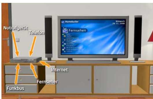
Bild 3 schematische Darstellung des Homebutler Centers mit Set-Top-Box und Fernseher
