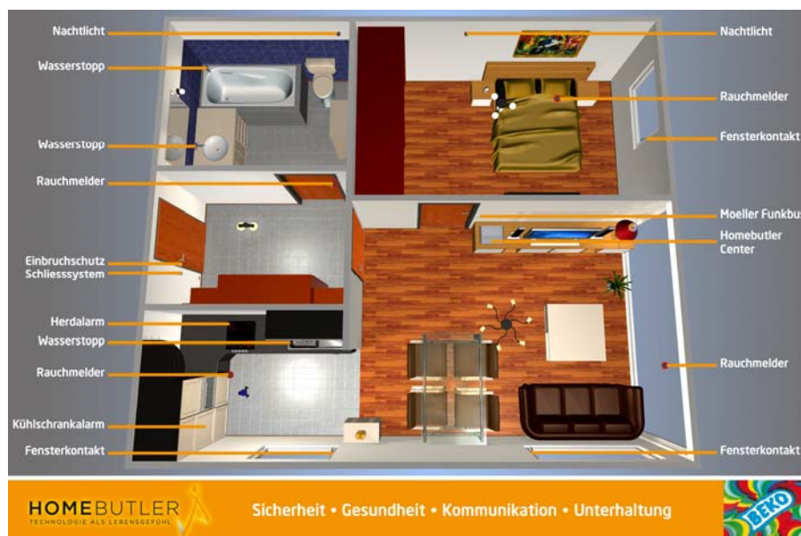
Bild 4 Modell und Sensorausstattung einer Homebutler-Installation in einer Testwohnung in Linz
